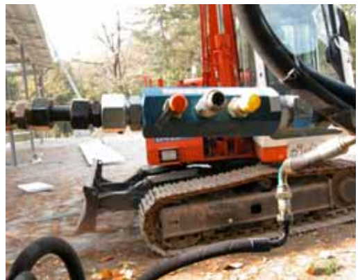
<그림 31> 원목절단 작업 및 유압포트 부착광경
