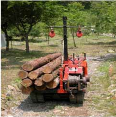
〈그림 32〉 측면적재형 및 후면적재형 임내작업차
