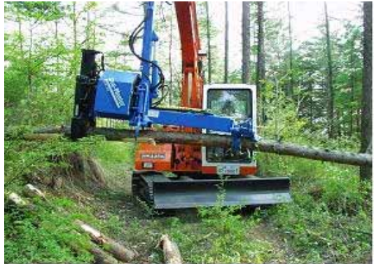
〈그림 71〉 스트로크 하베스터 벌목작업광경 〈그림 72〉 스트로크 하베스터 조재작업광경
