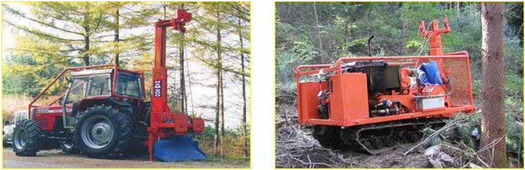
〈그림 80〉 HAM 200 간이 타워야더(좌) 및 복부집재기(우)
