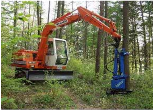
〈그림 71〉 스트로크 하베스터 벌목작업광경 〈그림 72〉 스트로크 하베스터 조재작업광경
