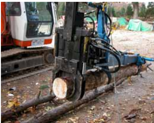
<그림 31> 원목절단 작업 및 유압포트 부착광경
