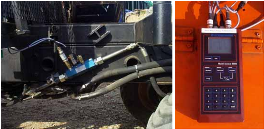
〈그림 17〉 센서 부착위치 및 유압계측 데이터로거
