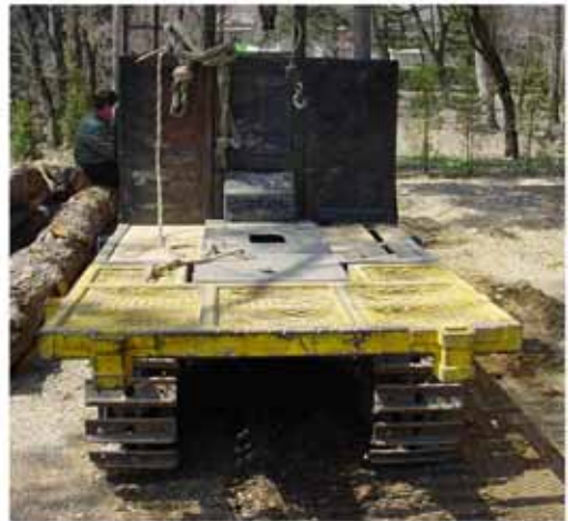
〈그림 32〉 측면적재형 및 후면적재형 임내작업차
