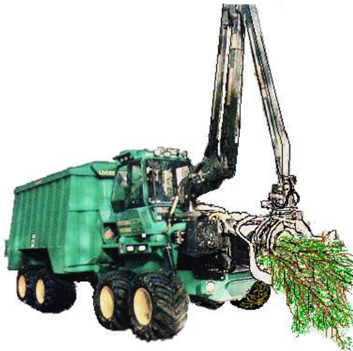
〈그림 2〉 치핑 및 운반이 가능한 칩하베스터
